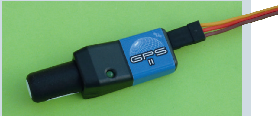
So ist das Patchkabel richtig angesteckt
