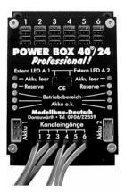
Mit sieben Servoimpulsverstärkern, zwei unabhängigen Spannungswächtern und geregelter Empfängerstromversorgung
