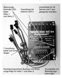
Der Anschluss der beiden Akkus erfolgt über die beiden Hochstrombuchsen. Prinzipiell funktioniert die **PowerBox 40/24 Professional** auch mit einem Akku, die Sicherheit einer Doppelstromversorgung ist dann aber nicht gegeben.
