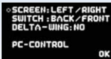
Mit **SCREEN** ist die Position des OLED Bildschirms im Modell gemeint, mit **SWITCH** die Buchse des **SensorSchalters**.
